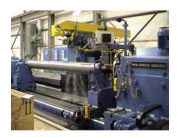
GRINDING **ROLLS TO** PROPER SURFACE FINISH
